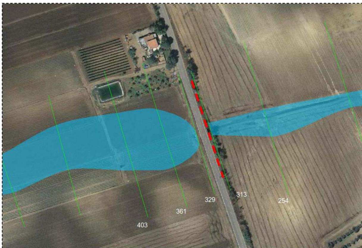
Fig. 13 Area "B". Particolare del tratto di cavidotto a realizzarsi con tecnica T.O.C
