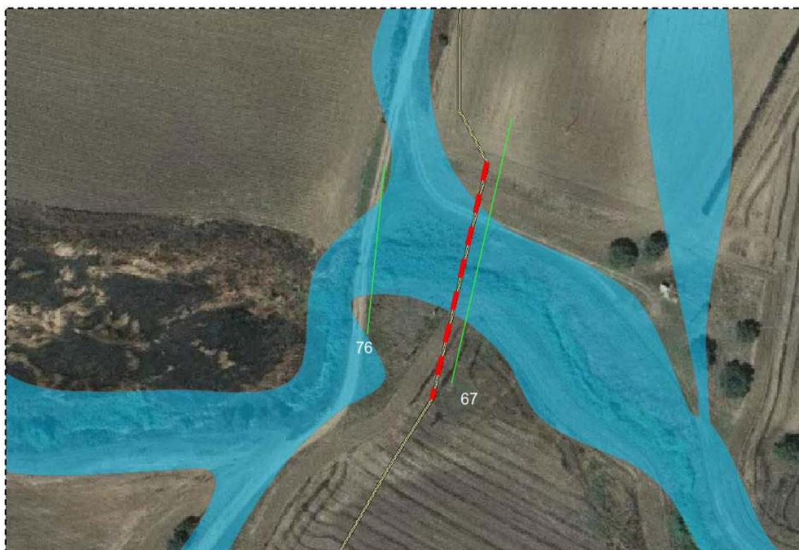
Fig. 21 Area "E Centro". Particolare del tratto di cavidotto a realizzarsi con tecnica T.O.C
