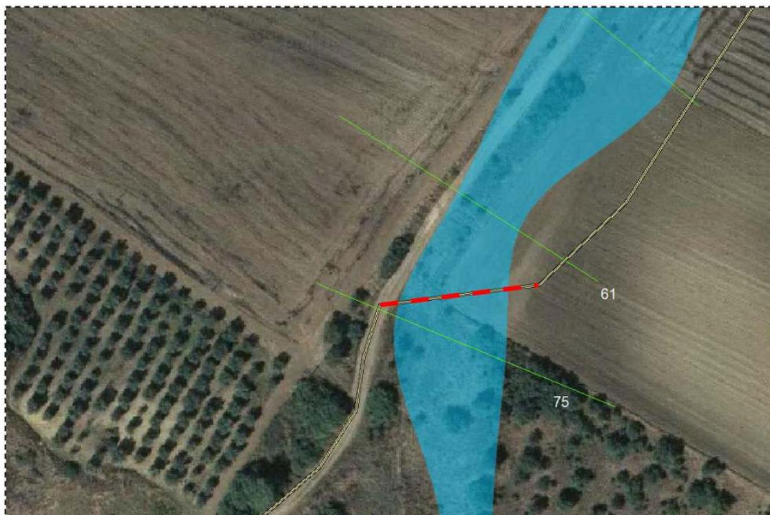
Fig. 23 Area "E Sud". Particolare del tratto di cavidotto a realizzarsi con tecnica T.O.C
