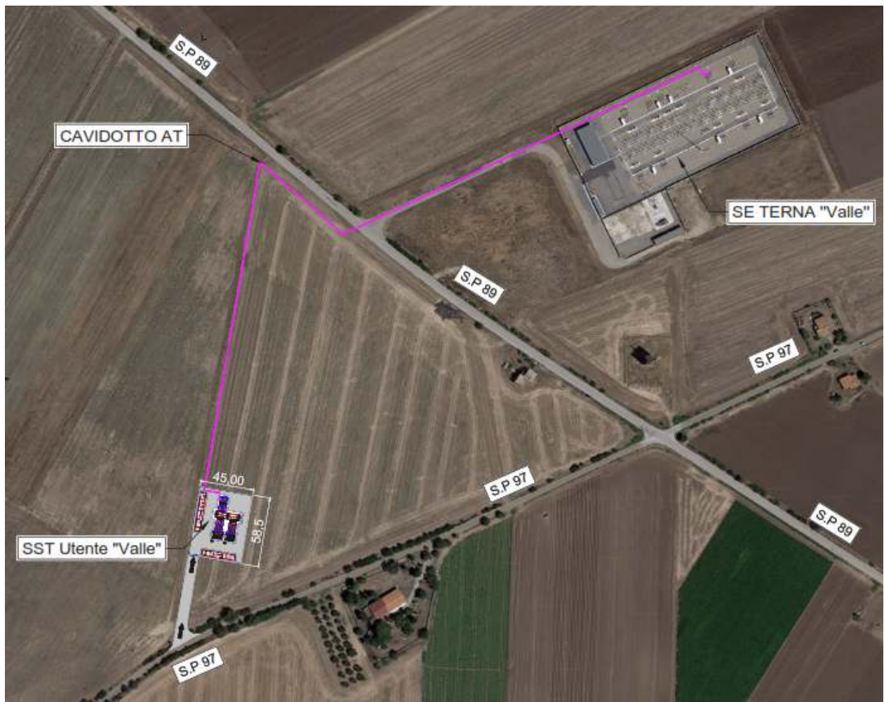
Fig. 4 Ortofoto ubicazione Sottostazione Utente e Stazione Terna
