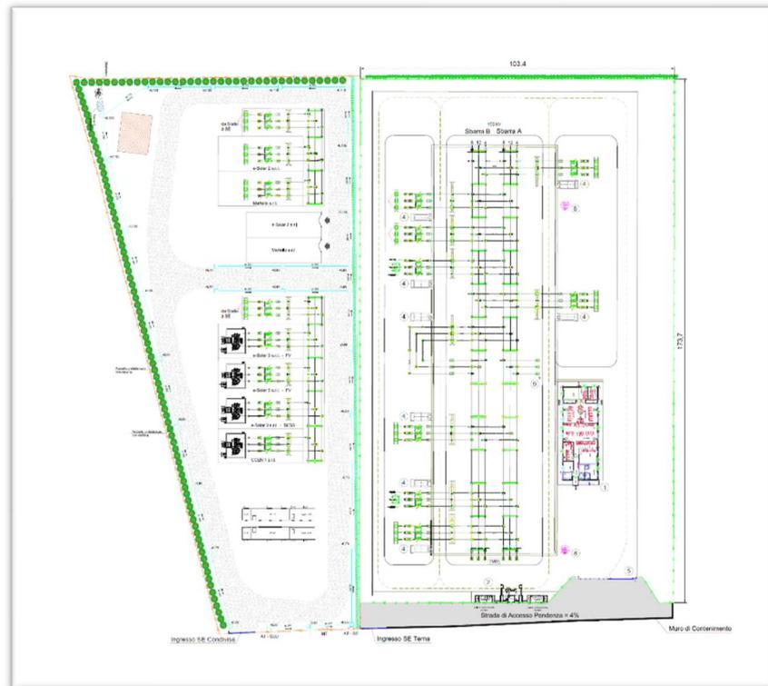
Figura 8 - Elettromeccanico SE RTN 150kV e SEU Condivisa
