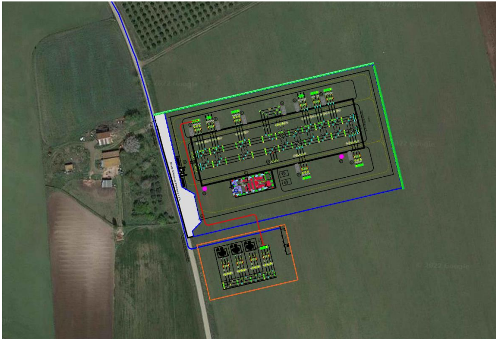
Figura 17 – Cavidotto in AT (in rosso) di collegamento tra la SEU e la SSE RTN
