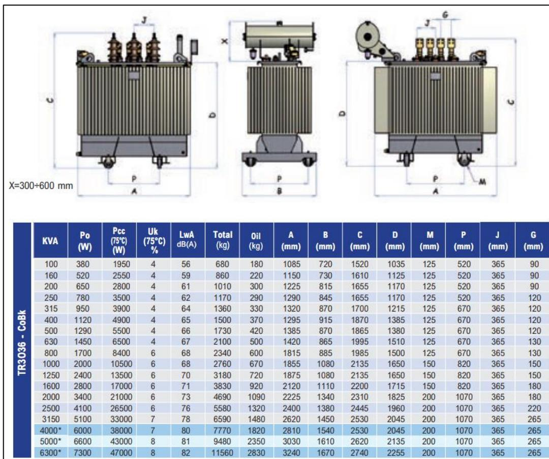
Figura 5 – Caratteristiche del trasformatore BT/MT in cabina di trasformazione
