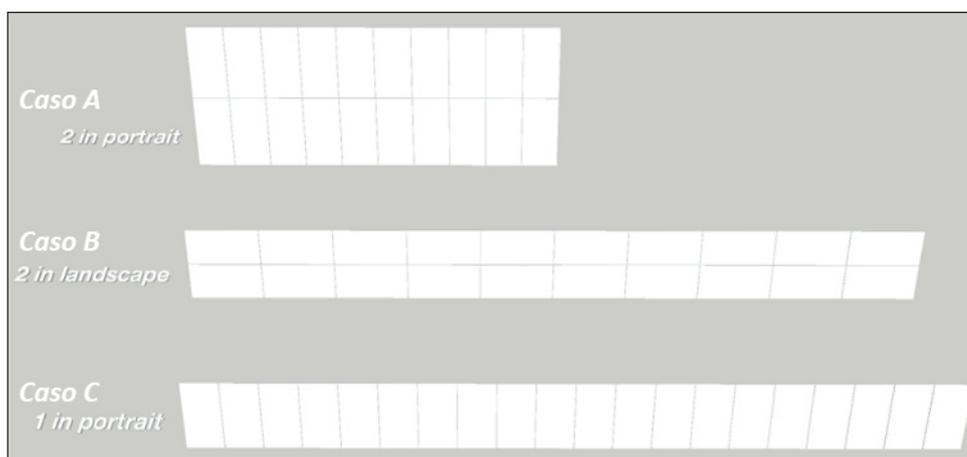
Figura 8 – Differenti configurazioni degli inseguitori solari monoassiali
