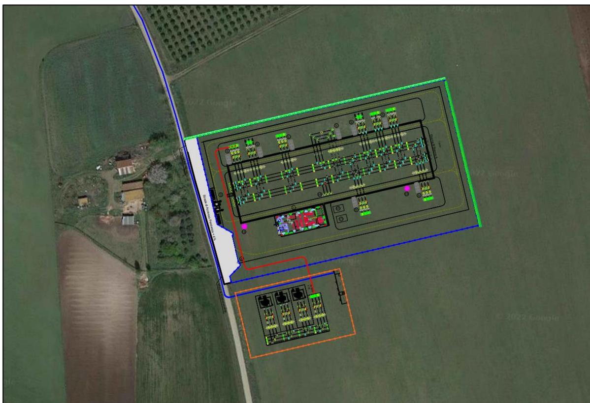
Figura 14 – Stralcio su ortofoto della posizione della stazione utente, del cavidotto in AT e la Stazione RTN lato 150 kV
