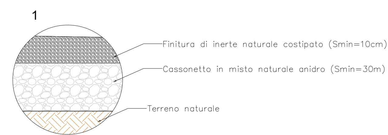
PARTICOLARE 1 - STRUTTURA STRADALE SCALA 1:20
