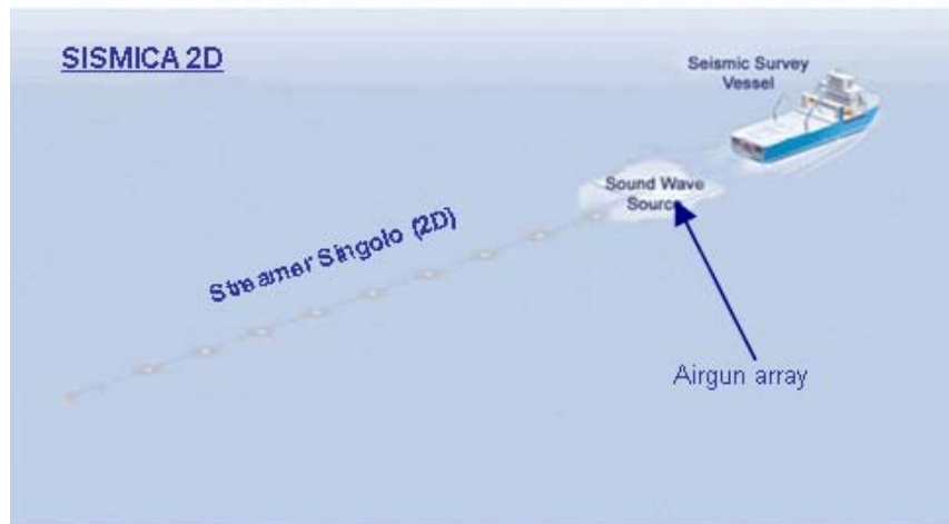
Figura 4.k: Schema Sismica 2D prevista per Vega B
