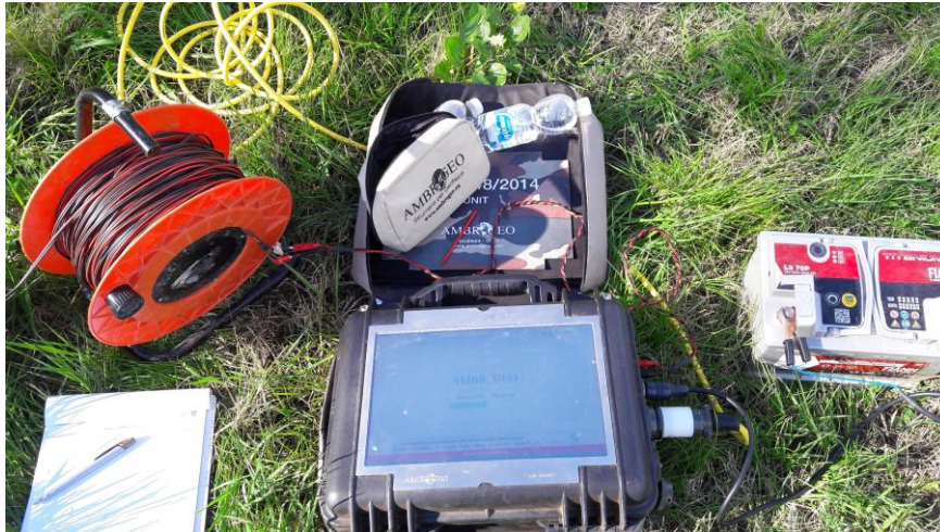
Figura 2.2.2.1: Sismografo digitale a 24 bit.
