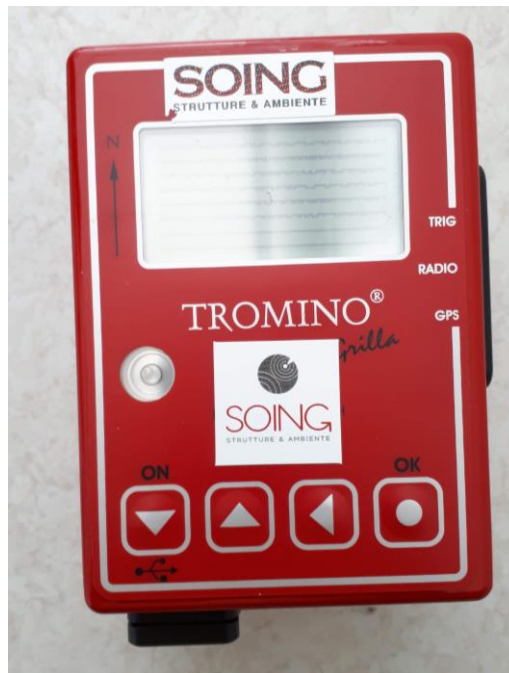
Figura 2.3.2.1: Tromografo per la misura microtremori - TROMINO©Engi.
