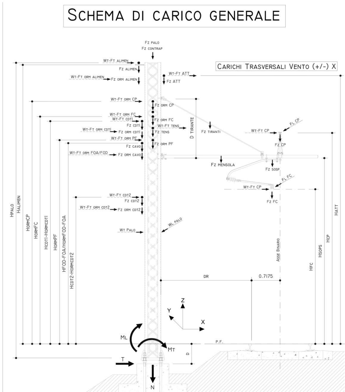
**CALCOLO e VERIFICA di strutture (pali, portali, travi e relativi blocchi di fondazione ecc) fuori standard Struttura 1**
