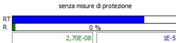
Poiché il rischio calcolato è inferiore al rischio tollerabile, la struttura risulta autoprotetta.
