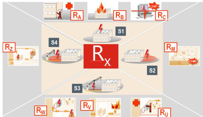
Sorgente di danno S1: Componenti di rischio per una struttura dovuto a fulminazione diretta della struttura
