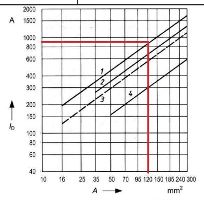
Le linee 1, 2 e 4 si riferiscono ad una temperatura finale di 300  $^{\circ}$ C, la linea 3 a quella di 150  $^{\circ}$ C. La Tabella D.2 contiene fattori per la conversione ad altre temperature finali.
