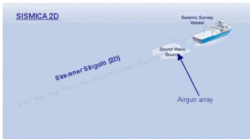
Figura 7.i: Schema Sismica 2D prevista per Vega B
