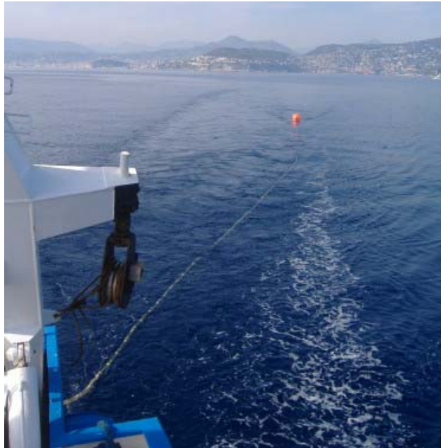
Figura 7.h: Messa a Mare di uno Streamer
