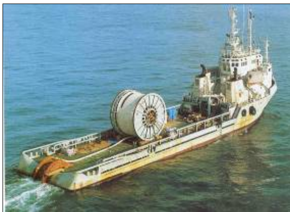
Figura 7.t: Installazione Tubazione Flessibile: Supply Vessel con Carousel montato sul Deck (sinistra) e Flex-Lay Vessel (destra)
