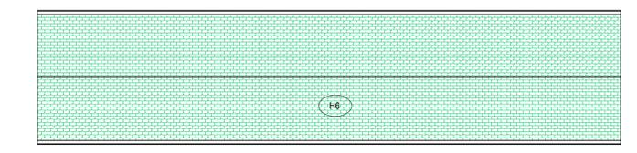
NB - Per garantire la resistenza dei tamponamenti alle azioni orizzontali, si prevede di inserire all'interno delle murature dei tralicci in acciaio inglobati nei letti di malta (per le caratteristiche tecniche dei tralicci si rimanda alla relazione di calcolo delle strutture).
