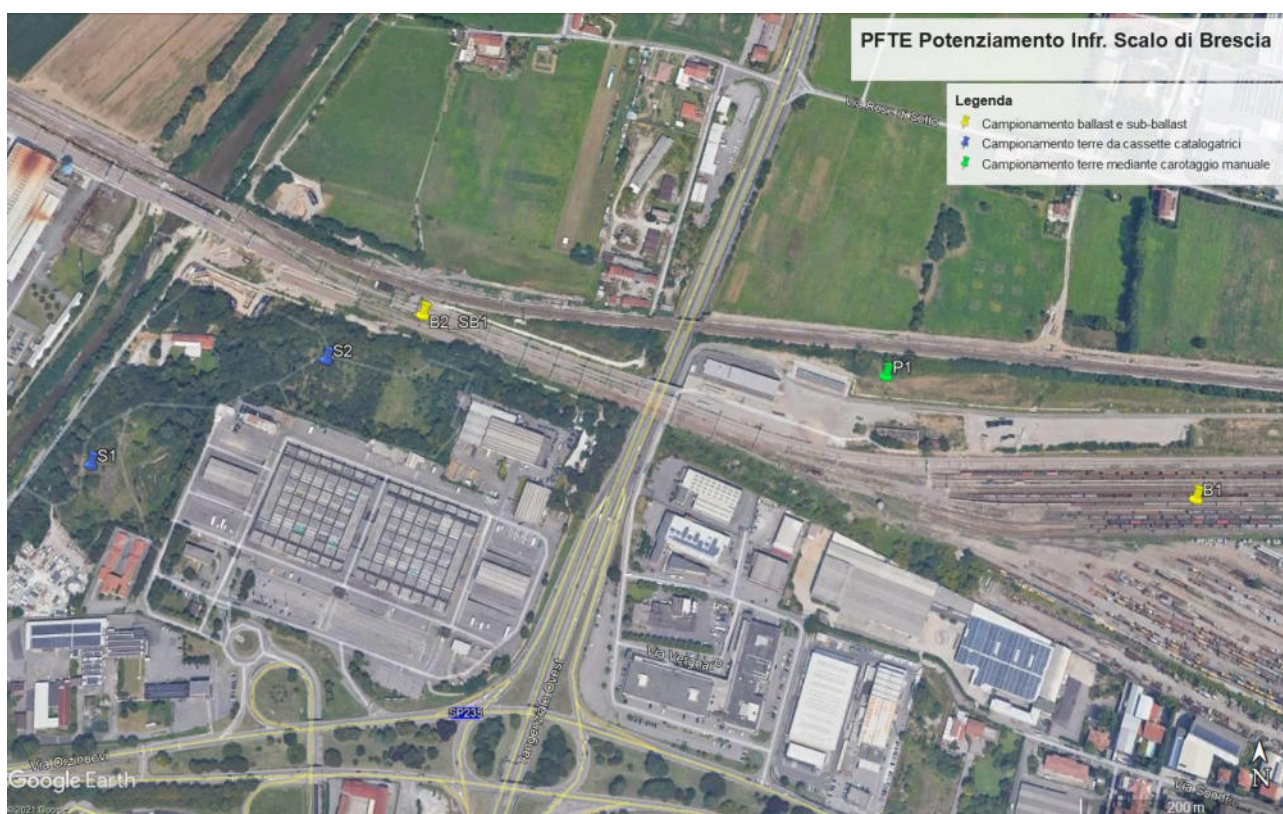
Figura 3-20 Ubicazione punti di sondaggio
