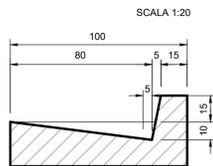
DETTAGLIO PAVIMENTAZIONE STRADALE
