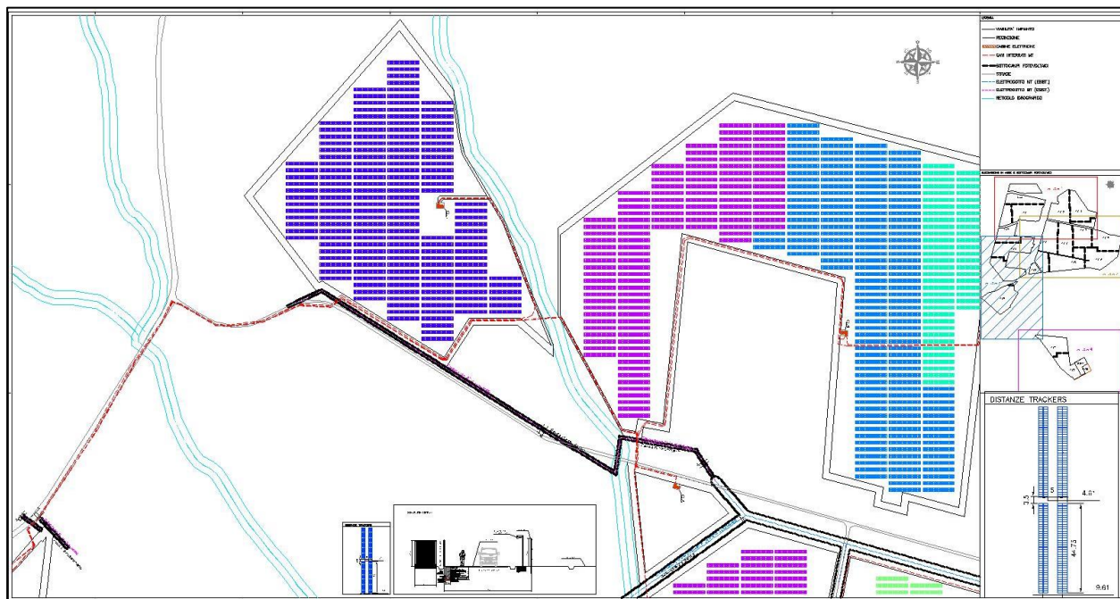
Figure 8: Layout impianto fotovoltaico AREA 3
