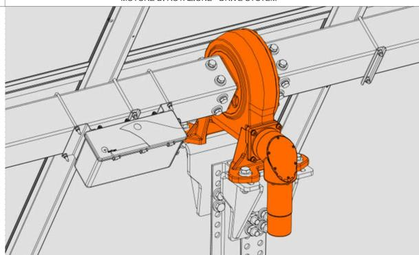
PARTICOLARE CONNESSIONE TRAVE - CERNIERA DI ROTAZIONE
