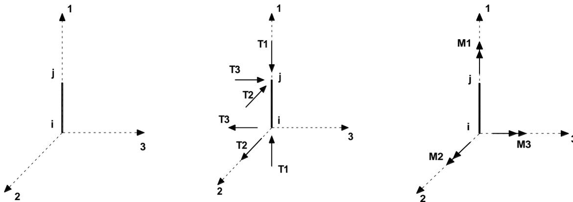
Definiti i e j come i due nodi iniziale e finale del pilastro, viene individuato un sistema di assi cartesiani 1-2-3 locale all'elemento, con origine nel Nodo i così composto:
