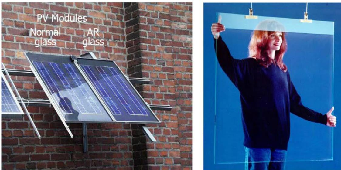
L'efficienza di conversione di una cella fotovoltaica dipende fortemente dalla sua capacità di assorbire la radiazione solare incidente. Tanto più una cella appare scura, tanto maggiore è la sua capacità di assorbire la luce. Per ridurre al minimo la riflessione della luce incidente sono state sviluppate diverse tecnologie capaci di ridurre la riflettanza superficiale delle celle solari a livelli prossimi all'1%.
