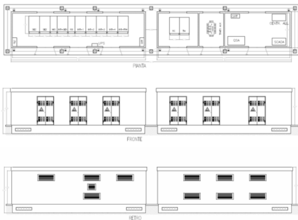
Figura 7. Tipologico delle cabine di centrale.
