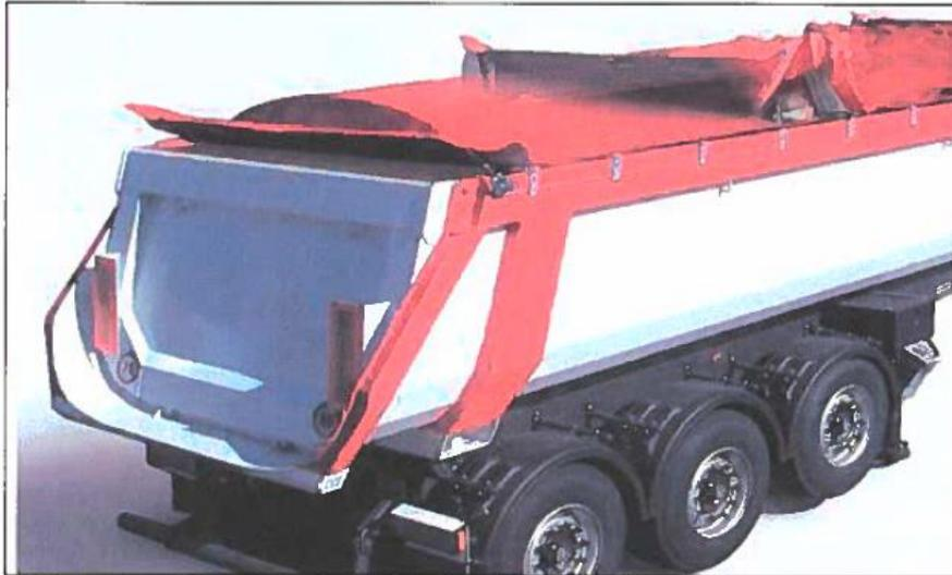
Figura 18. Sistema di copertura degli scarrabili di trasporto dei materiali.
