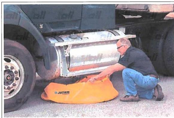
Figura 15. Vasche per il contenimento di sversamenti di mezzi d'opera
