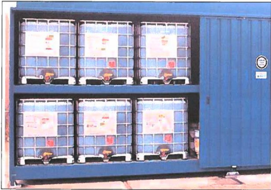
Figura 19. Sistemi di stoccaggio delle sostanze pericolose in container
