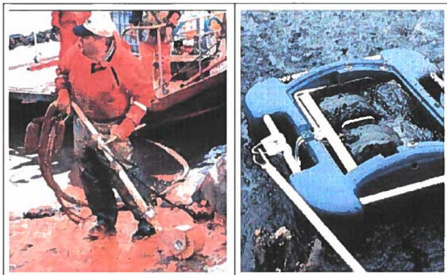
Figura 15. Skimmer in caso di sversamenti accidentali di olii e idrocarburi a terra (sx) ed a mare (dx)
