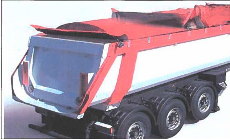
Figura 20. Sistema di copertura degli scarrabili di trasporto dei materiali.
