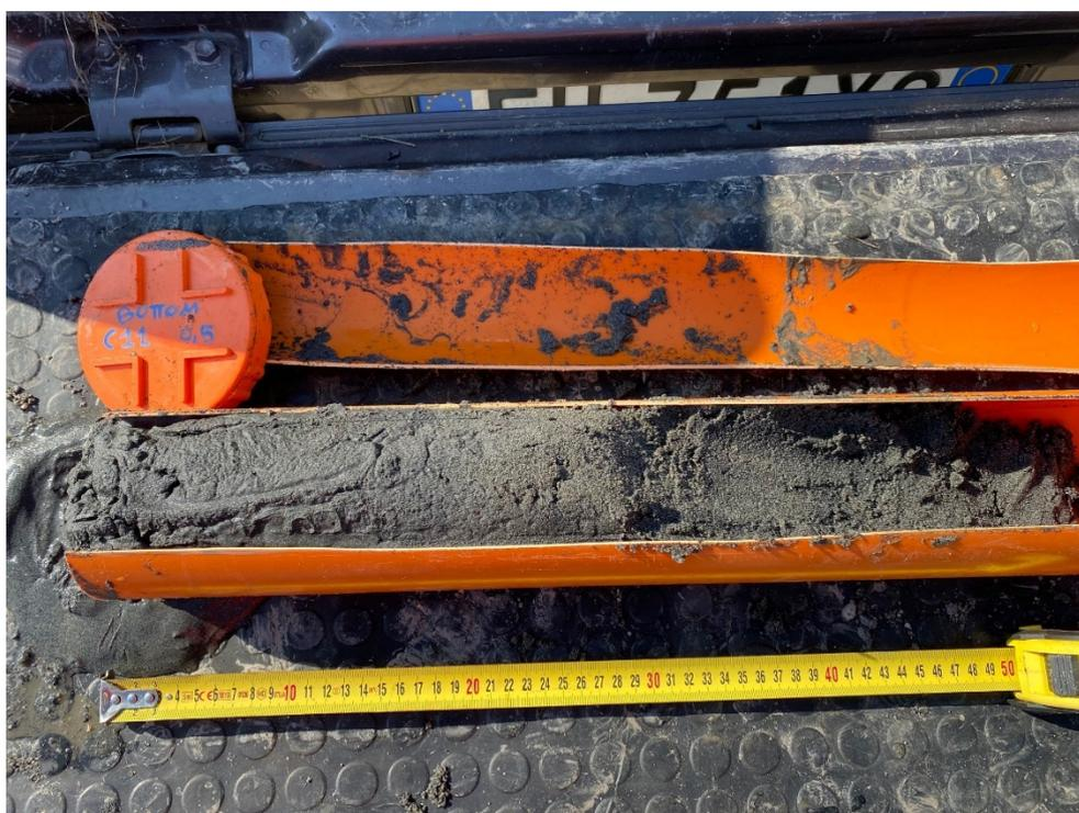
Figura 3.1-2. Apertura del liner contenente la carota e successivo campionamento.
