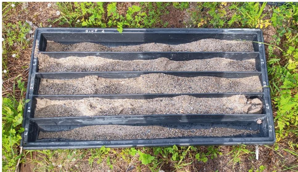
Figura 3.2-4. Cassetta catalogatrice contenente il sedimento carotato durante il sondaggio SINT4.
