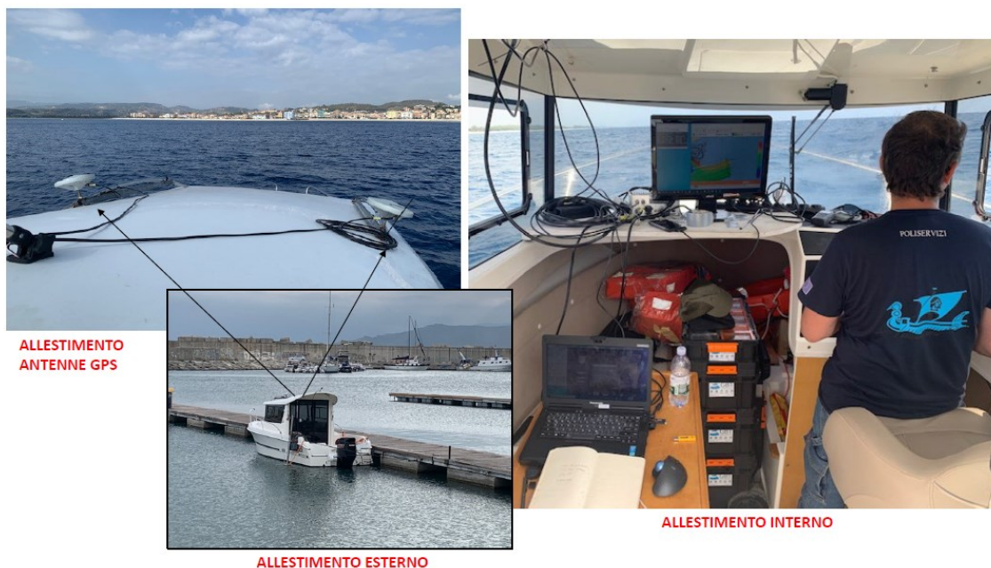
Figura 7. Sistema Applanix integrato al sistema MBES Norbit i77h; a sinistra sistema posizionamento superficiale a doppia antenna GPS in modalità RTK.
