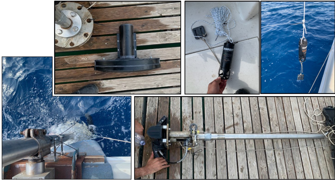
Figura 8. MBES NORBIT i77h montato a palo lungo giardinetto della motobarca Beam. In alto a dx si mostra la sonda di velocità SVP accompagnata dalle fasi di calata in acqua durante le operazioni di rilievo.
