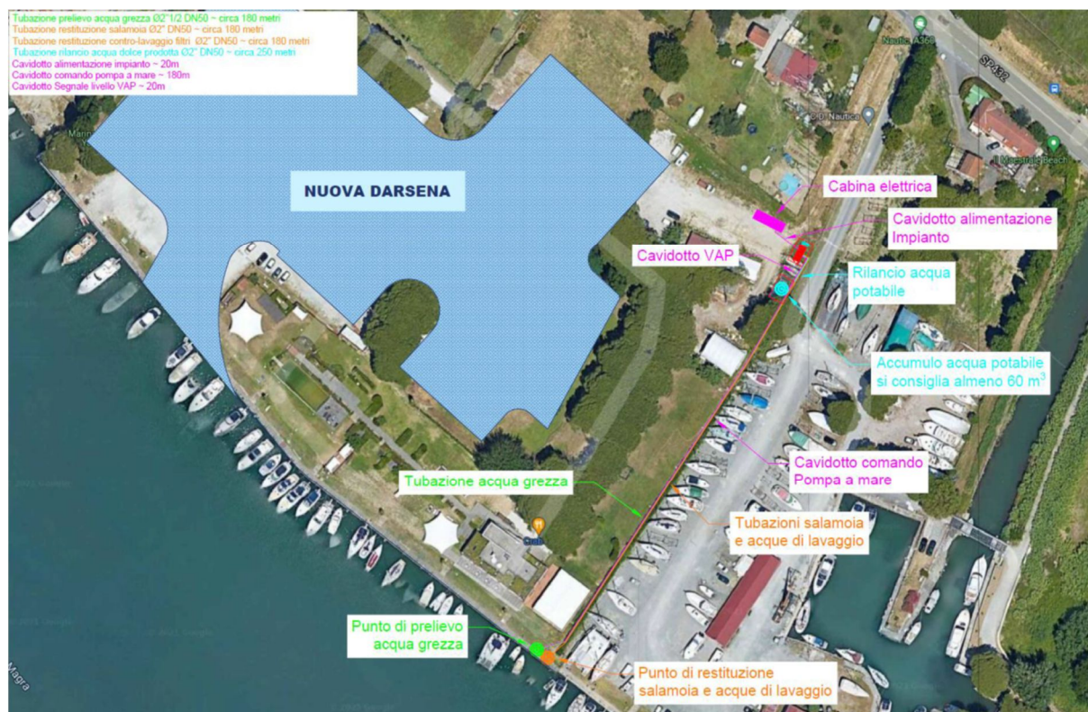
Fig. 46 – Ubicazione dell'impianto di dissalazione
