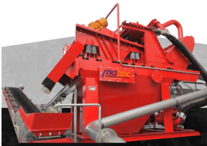
Fig. 21 – Sezione di vagliatura (a sinistra) e sezione di recupero delle sabbie (tabella a destra)
