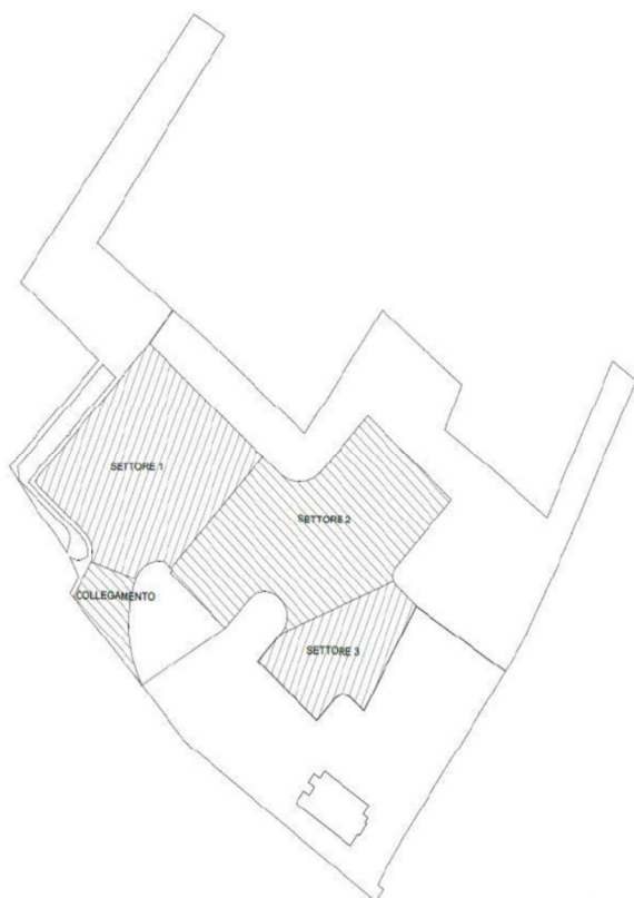
Fig. 19 – Individuazione dei settori di scavo
