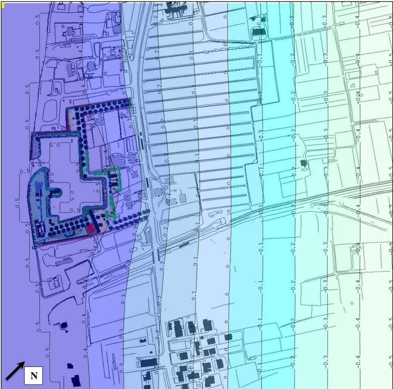
Figura 5. Altezza della superficie piezometrica simulata (m) – stato di progetto (post-operam), con presenza di scogliere a delimitare la superficie di scavo.
