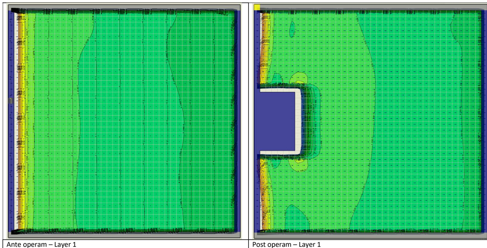
**Figura 13A. Simulazione numerica pregressa (Grassi e Curzio, 2018). Le curve evidenziano le altezze della superficie piezometrica e le linee di isoflusso del Layer 1 negli scenari ante- e post-operam (quest'ultimo in presenza di palancolature).**
