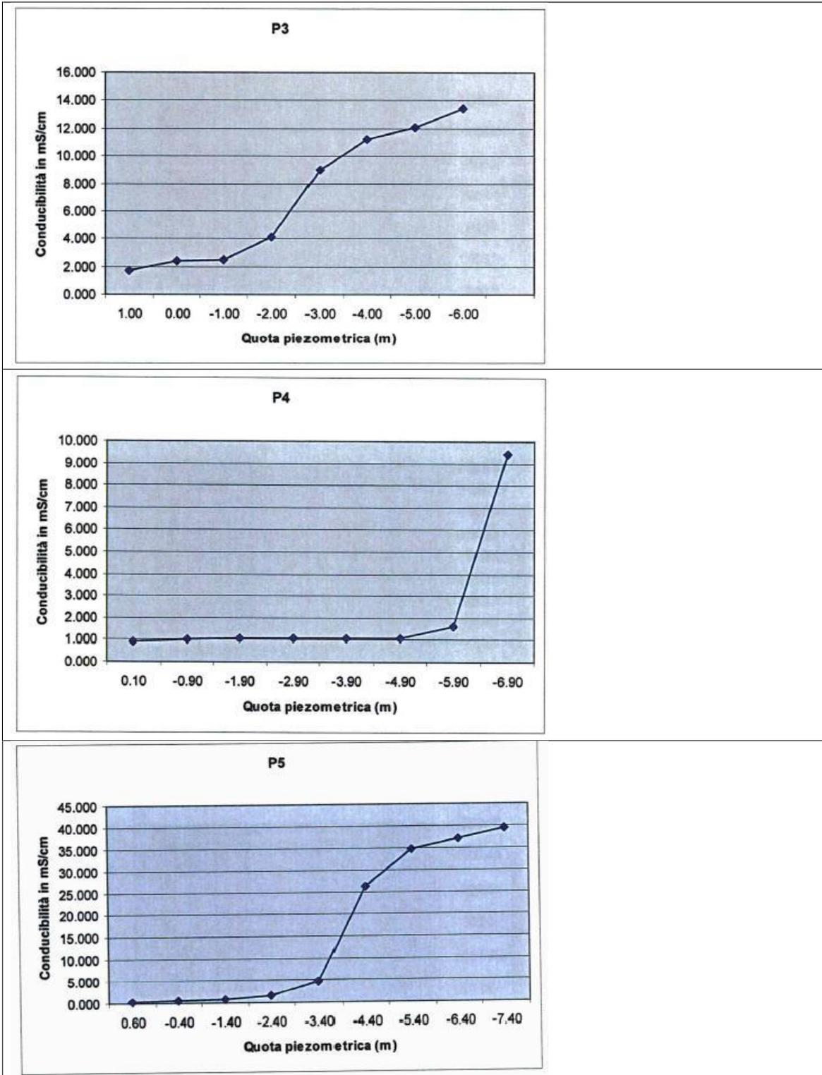
Figura 11A. conducibilità nei piezometri P3, P4 e P5 in data 17/05/2011.
