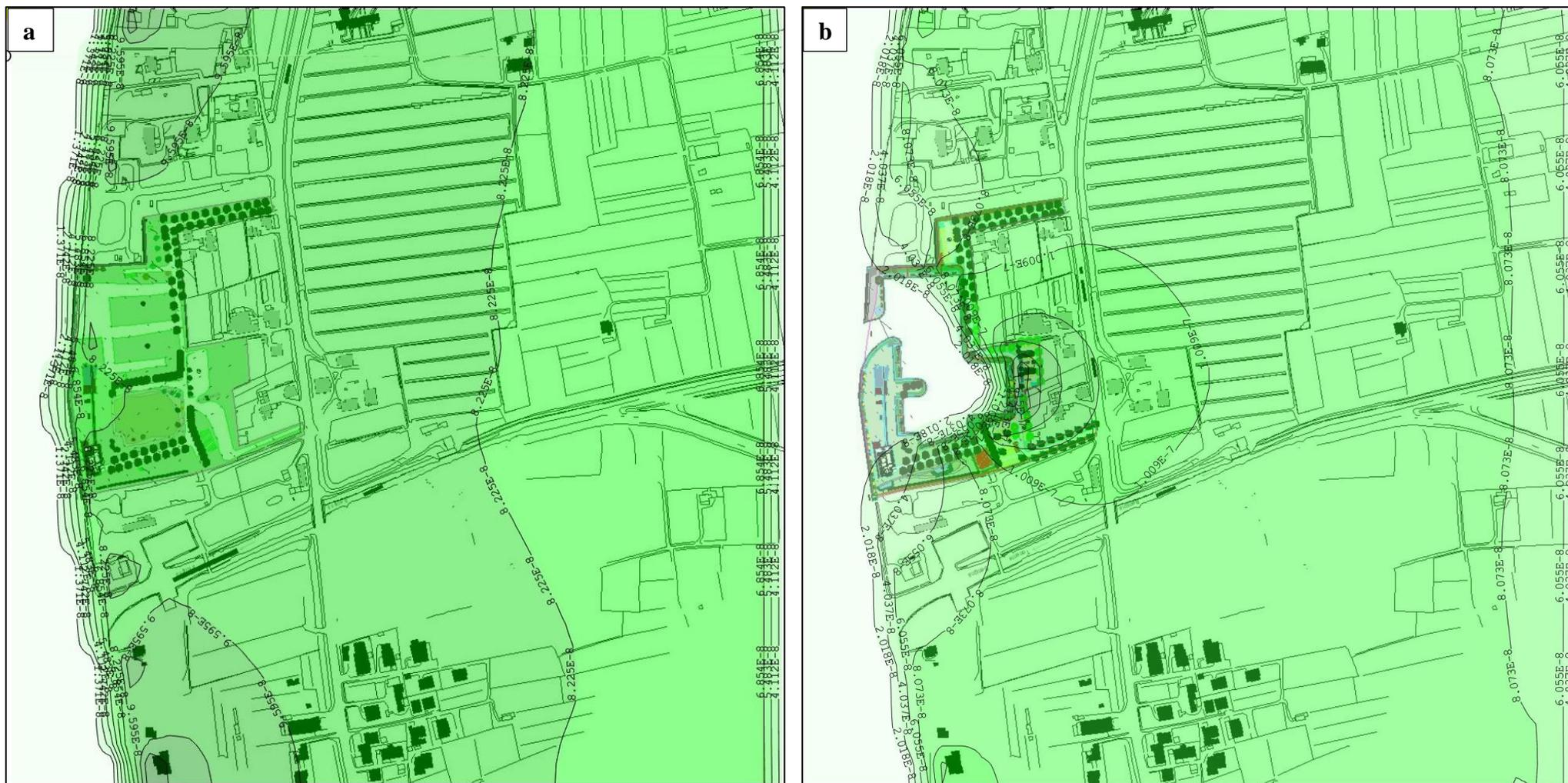
Figura 6. Flusso orizzontale (m<sup>3</sup>/s) nel layer 1. a) Stato attuale (ante-operam), b) stato di progetto (post-operam), con presenza di scogliere a delimitare la superficie di scavo.
