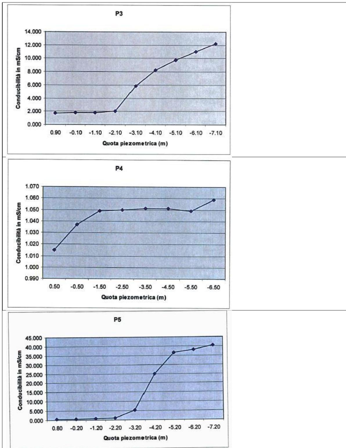
Figura 10A. conducibilità nei piezometri P3, P4 e P5 in data 8/02/2011.
