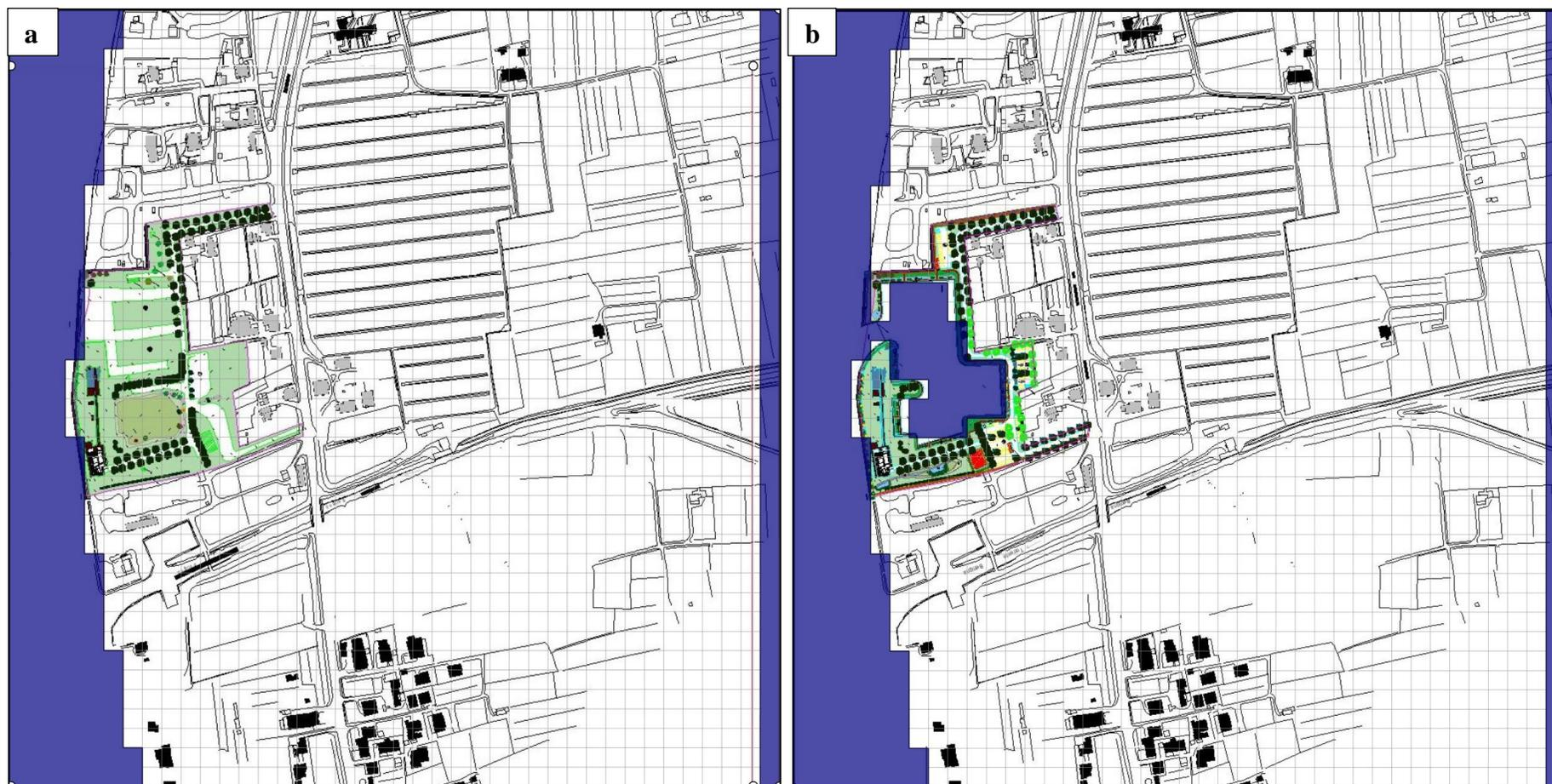
Figura 3 (nella pagina precedente). Set-up dei modelli in cui sono visibili la griglia del modello (piano x-y) e le condizioni al contorno (aree blu: IBOUND=-1 – constant head). a: stato attuale o ante-operam; b: stato di progetto o post-operam (presenza di scogliere intorno alla superficie di scavo).
