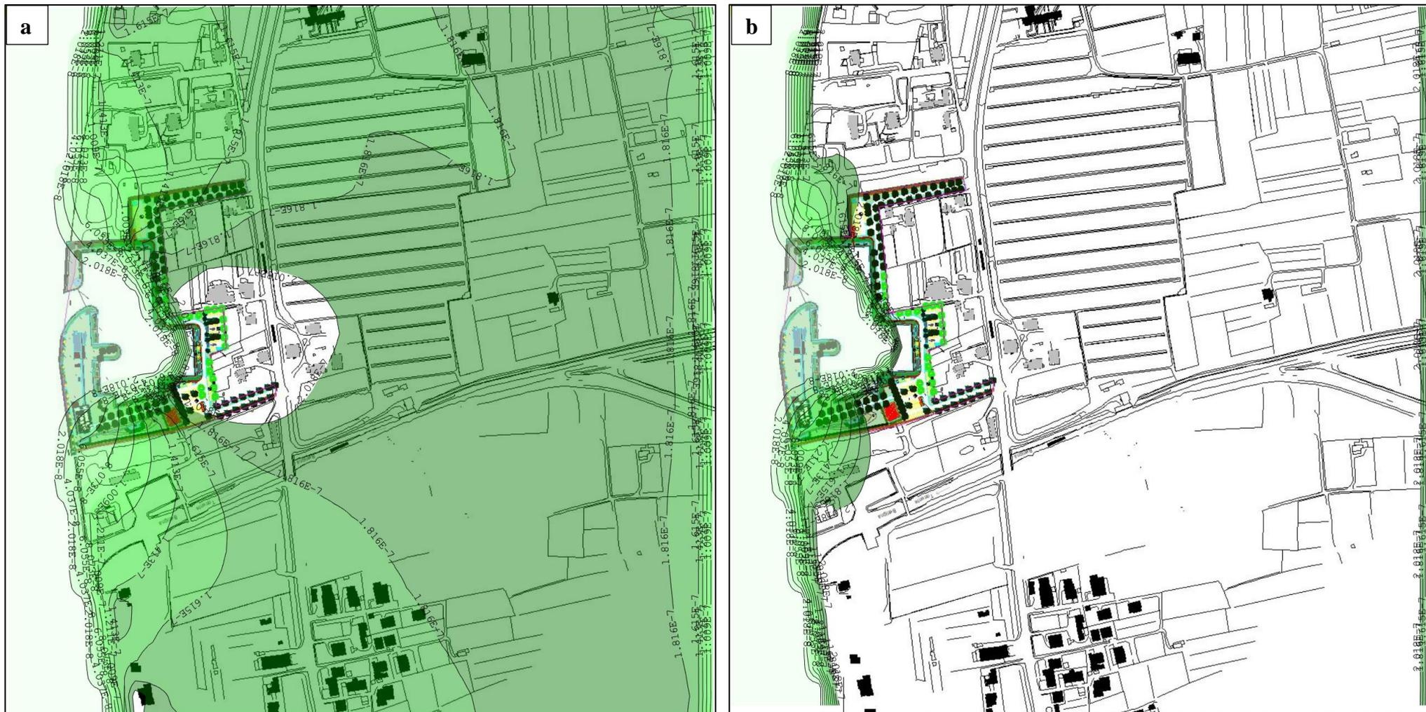
Figura 7. Flusso orizzontale (m<sup>3</sup>/s) nello stato di progetto (post-operam), con presenza di scogliere a delimitare la superficie di scavo. a) Layer 2. b) Layer 3.
