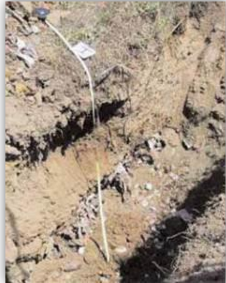
Figura 7-3: Scavo realizzato con pala meccanica. Consente di osservare la sequenza litologica sulle pareti dello scavo stesso e di verificare la presenza di una falda superficiale.
