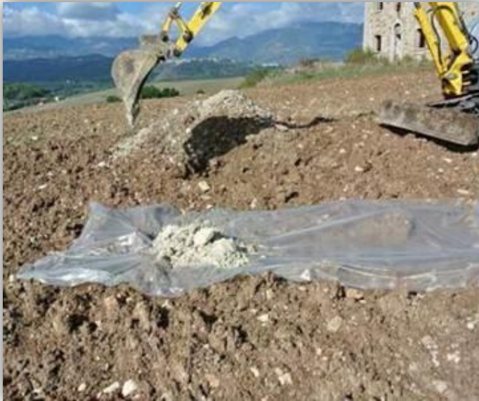
Figura 7-3: Scavo realizzato con pala meccanica. Consente di osservare la sequenza litologica sulle pareti dello scavo stesso e di verificare la presenza di una falda superficiale.
