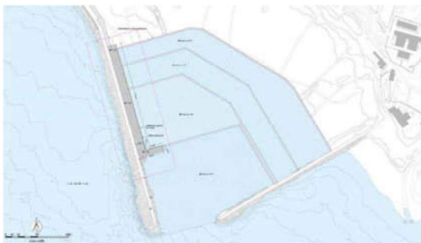
Figura 2 – Nuova banchina a seguito dei lavori di dragaggio
