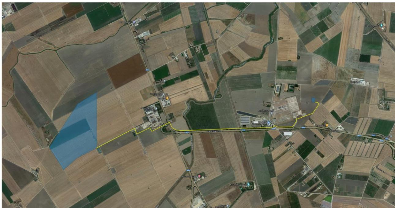
Figura 4-3: Zone IBA, in blu la perimetrazione del sito oggetto di DDS, in rosso il perimetro dell'impianto,, in giallo il tracciato della connessione
