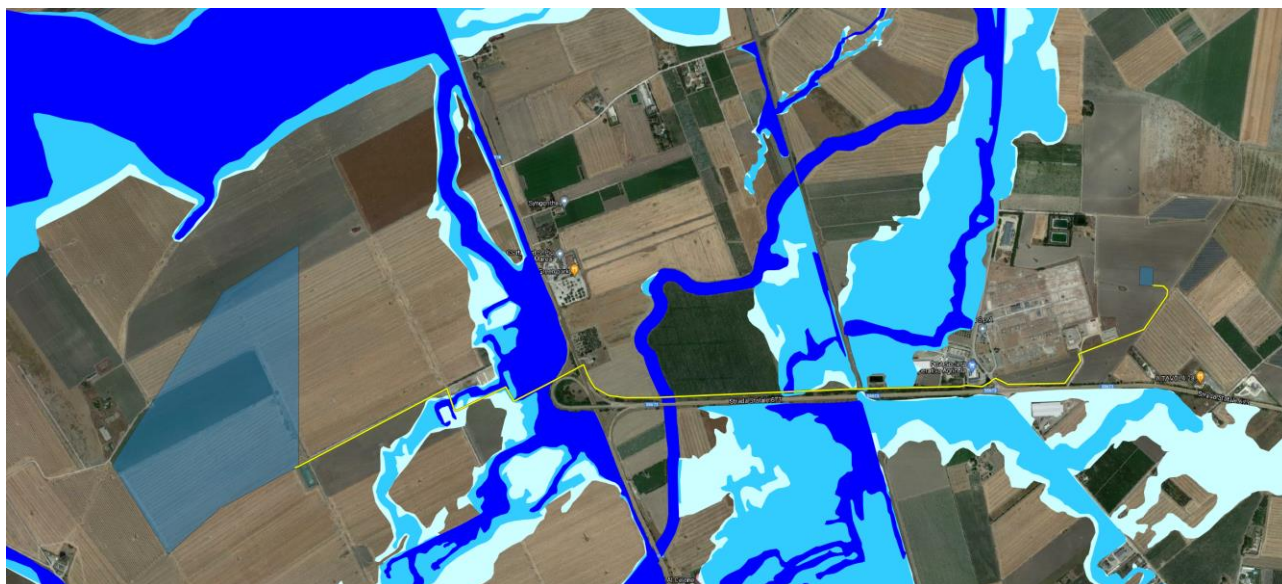
Figura 10-3: PAI – Pericolosità Frane e Inondazioni, in blu le aree di impianto e in giallo il tracciato dell'elettrodotto
