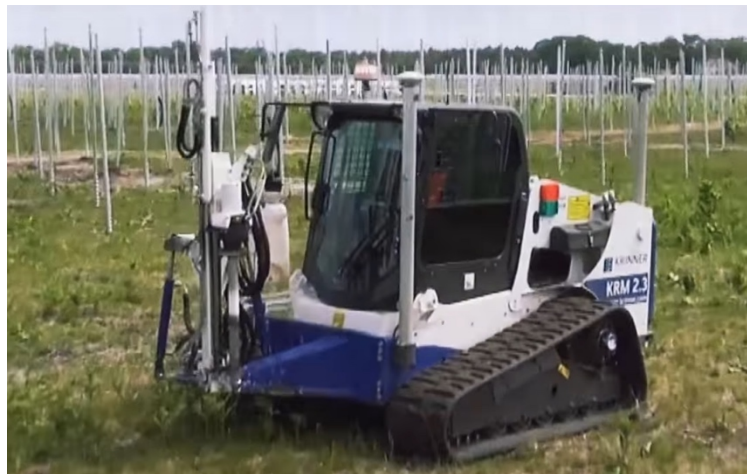
Fig. 2. Esempio di fissaggio delle strutture di supporto
