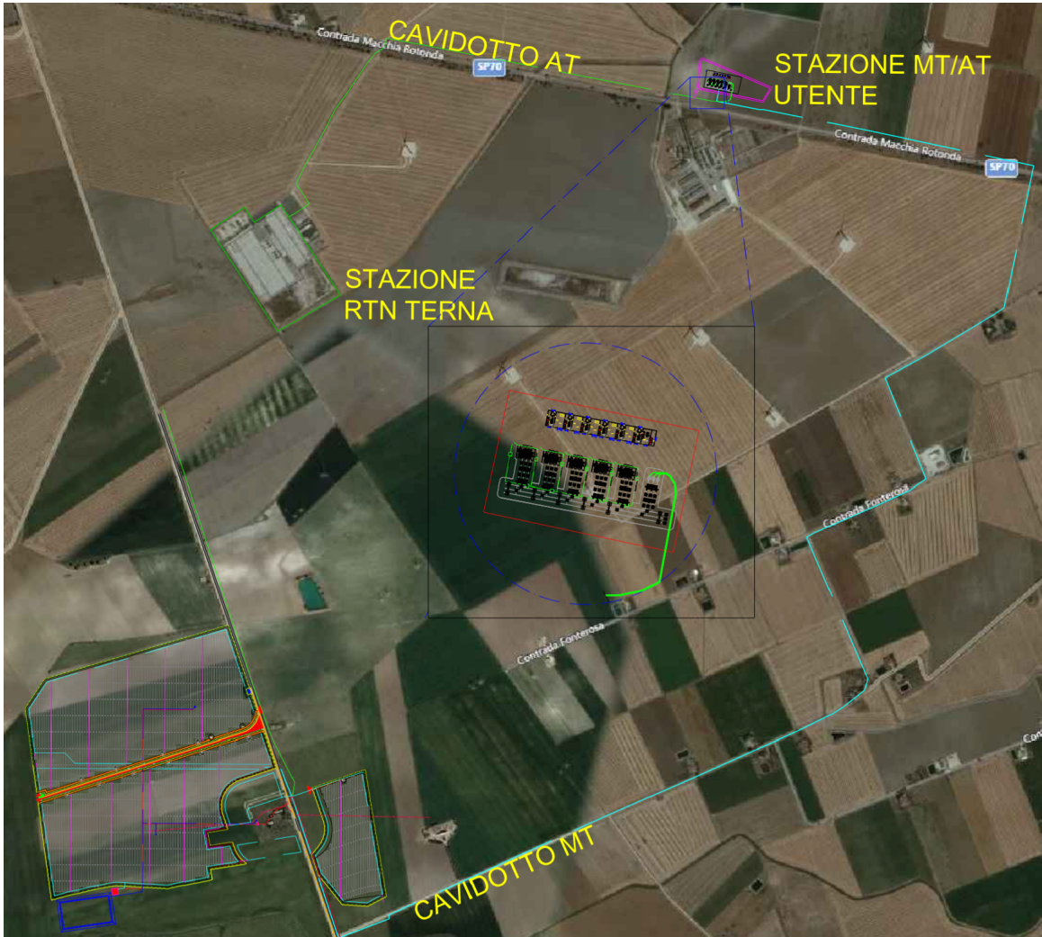
Figura 3.2: In blu il percorso di connessione dal campo FV alla Sottostazione AT 380/150 kV Foggia
