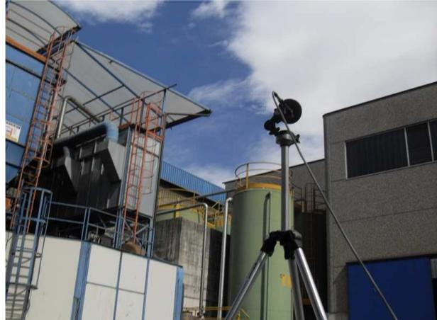
Il punto di misura numero 3 si trova sul confine Ovest. Dal punto di vista acustico è influenzato in particolar modo dalla rumorosità proveniente dagli impianti di abbattimento a servizio delle emissioni in atmosfera, e dal carico / scarico dei mezzi pesanti.
