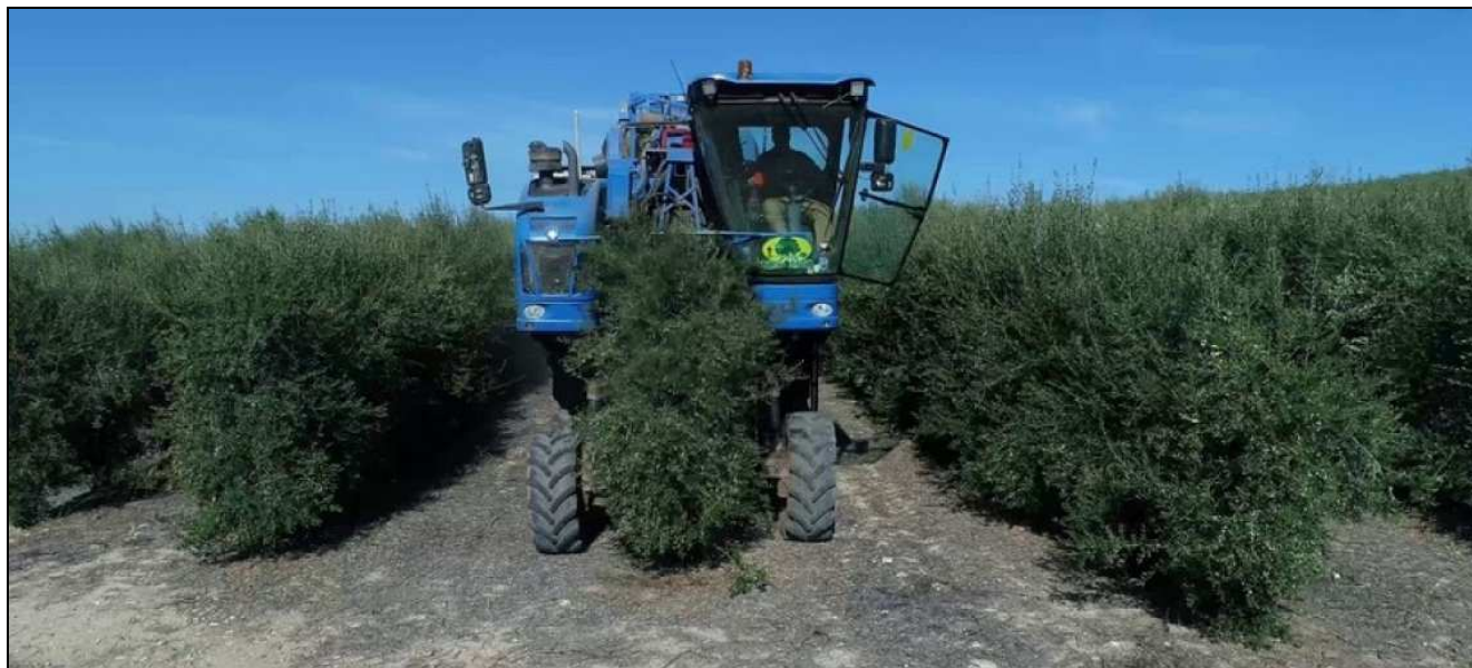
Esempio di raccolta meccanizzata con macchina scavallatrice
