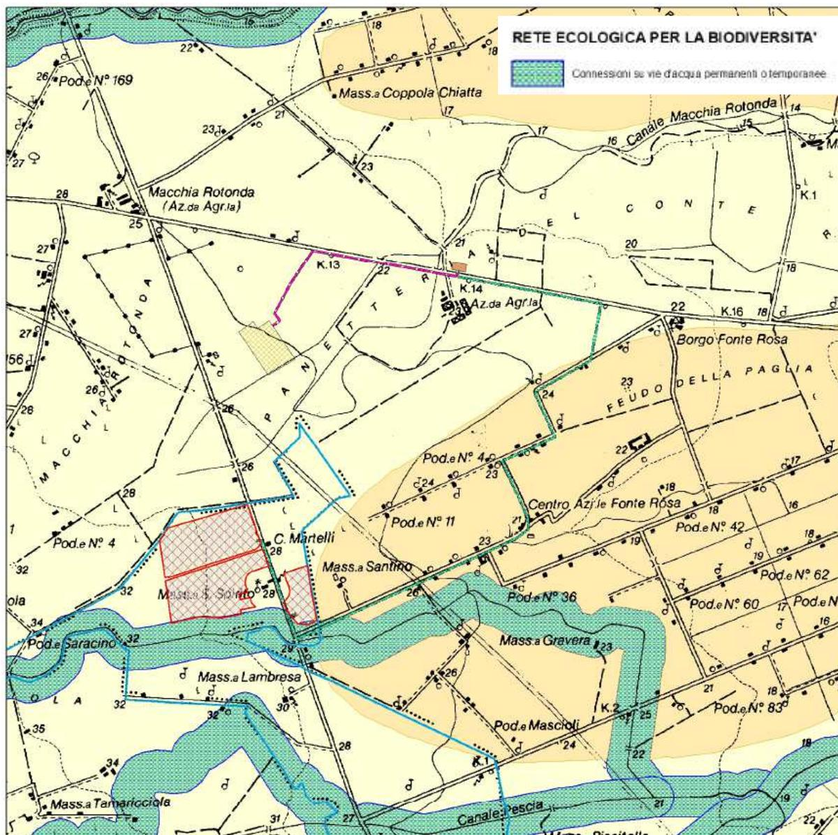
Si evidenzia che l'impianto fotovoltaico in progetto risulti totalmente esterno alla suddetta connessione ecologica. Infatti, soltanto i filari di olivo rientreranno nell'ambito della connessione ecologica "Canale carapelluzzo", i pannelli, invece risulteranno esterni, come evidenziato nell'immagine di seguito riportata.
