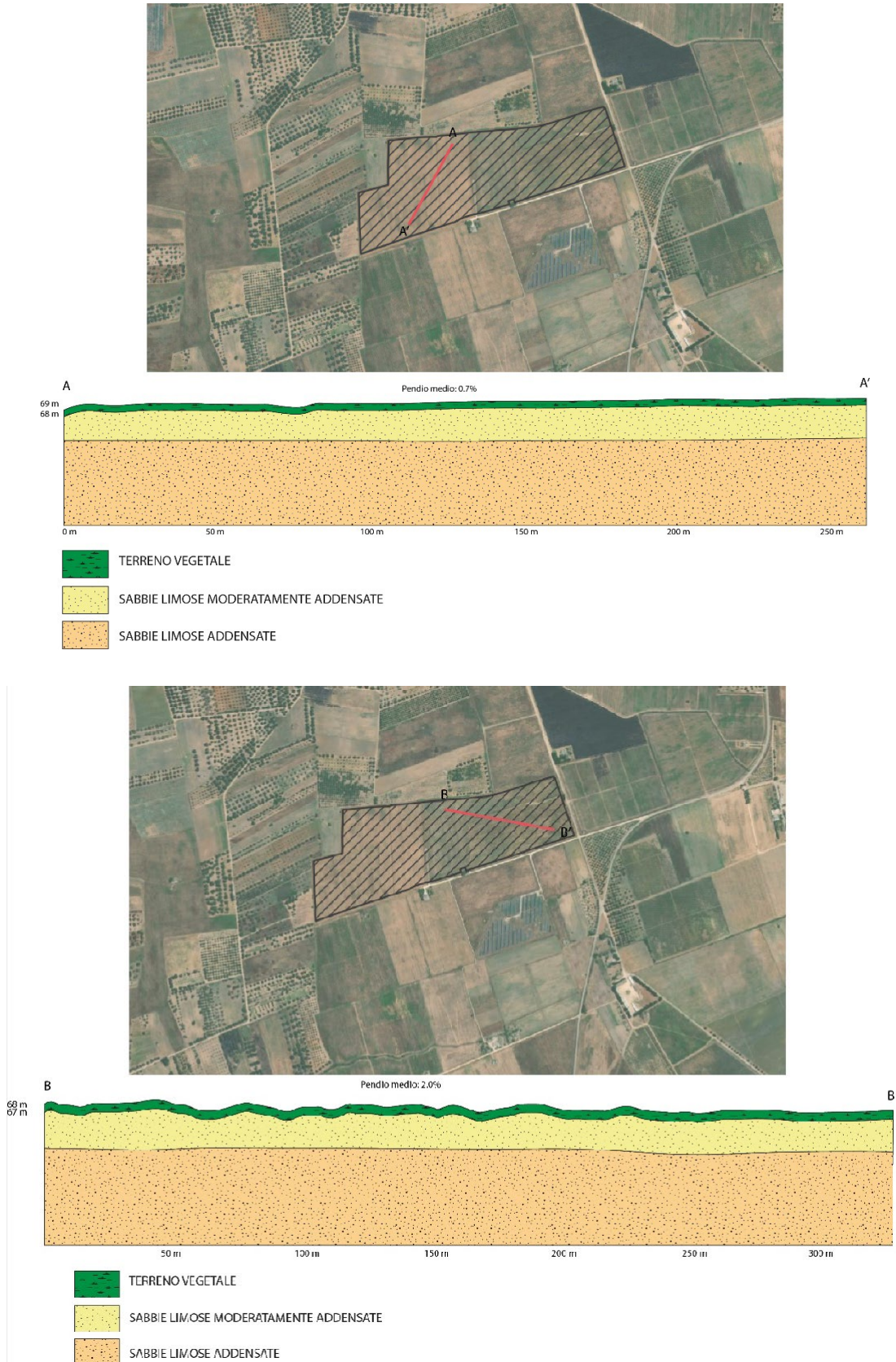
Fig. 9: Sezioni geologiche di dettaglio dell'area in esame
