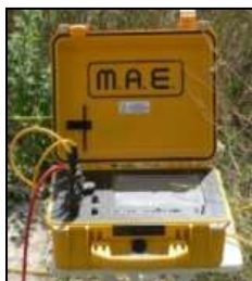
Fig. 2: sismografo multicanale M.A.E. modello A 6000 S.
