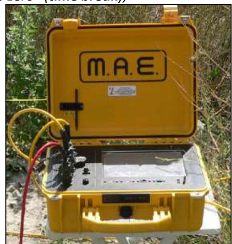
Fig. 3: sismografo multicanale M.A.E. modello A 6000 S.
