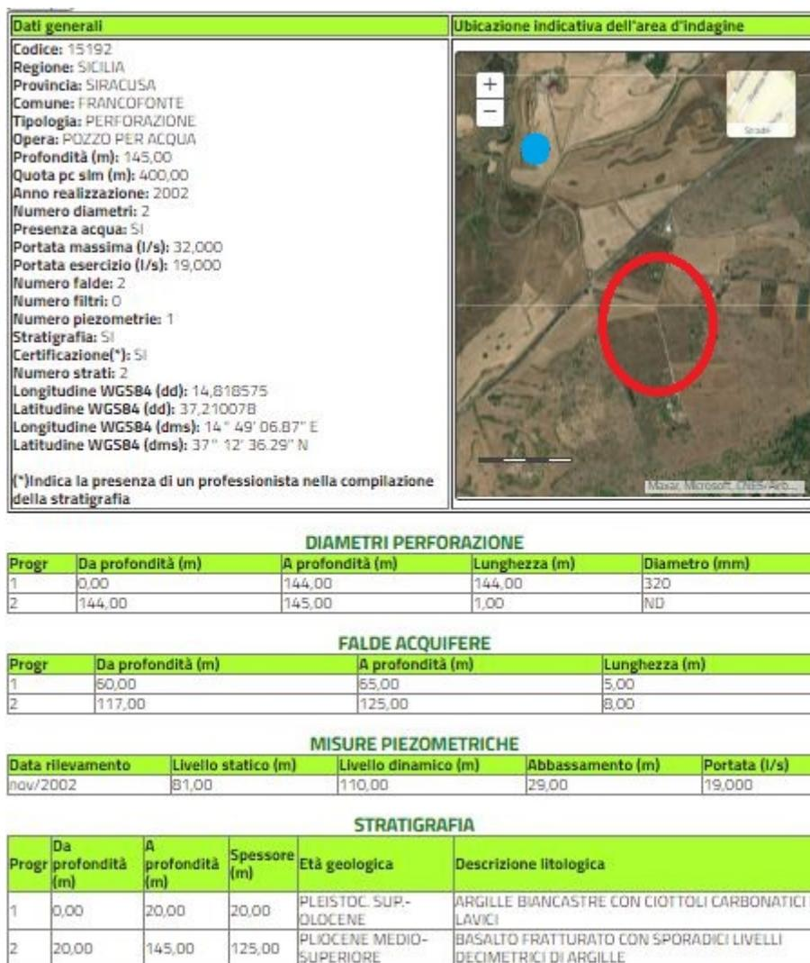
**Fig. 5 - Lo schema in figura rappresenta le caratteristiche principali del pozzo in questione. L'ellisse rosso indica l'ubicazione del sito in esame e il pallino azzurro rappresenta l'ubicazione del pozzo. La distanza tra sito e pozzo è di circa 700 m lineari con quote altimetriche simili.**
