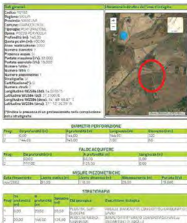
Figura 13 - caratteristiche principali del pozzo in questione. L'ellisse rosso indica l'ubicazione del sito in esame e il pallino azzurro rappresenta l'ubicazione del pozzo. La distanza tra sito e pozzo è di circa 700 m lineari con quote altimetriche simili
