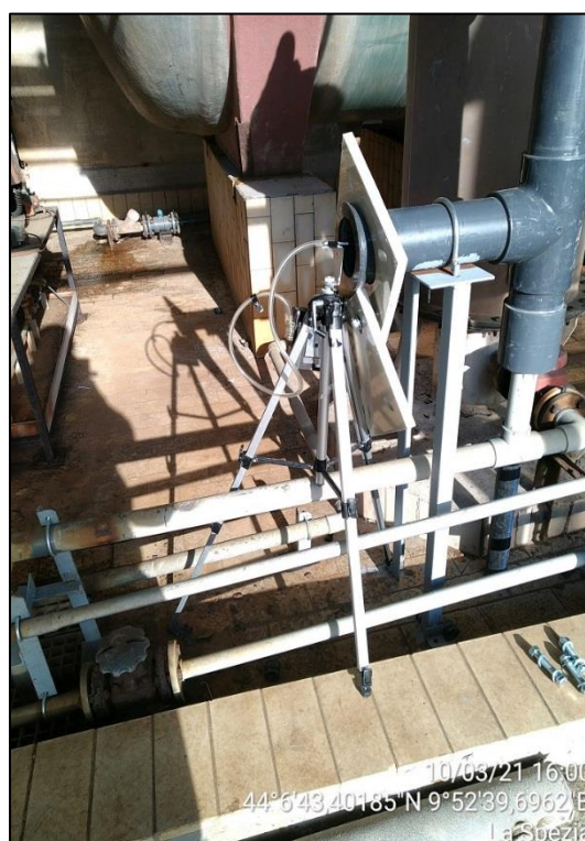
Foto 2 – Serbatoio di HCl, foto con il bocchello costruito sulla tubazione di sfiato della guardia idraulica e con il campionatore CESI
