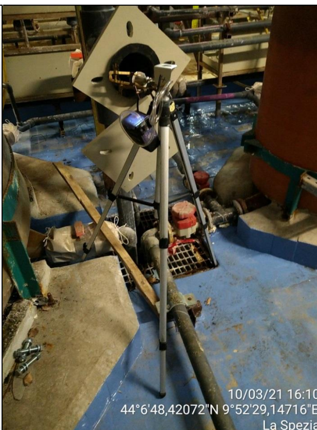
Foto 8 – Serbatoio di NaOH, foto con il bocchello costruito sulla tubazione di sfiato e con il campionatore CESI
