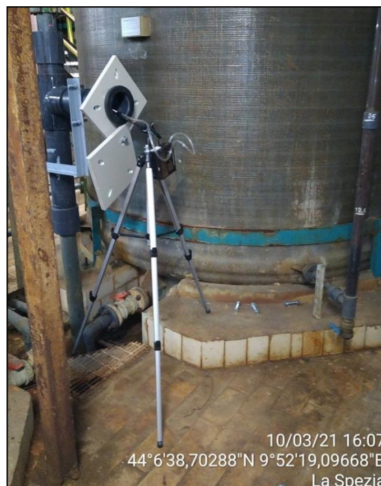
Foto 6 – Serbatoio di \text{FeCl}_3 , foto con il bocchello costruito sulla tubazione di sfiato e con il campionatore CESI
