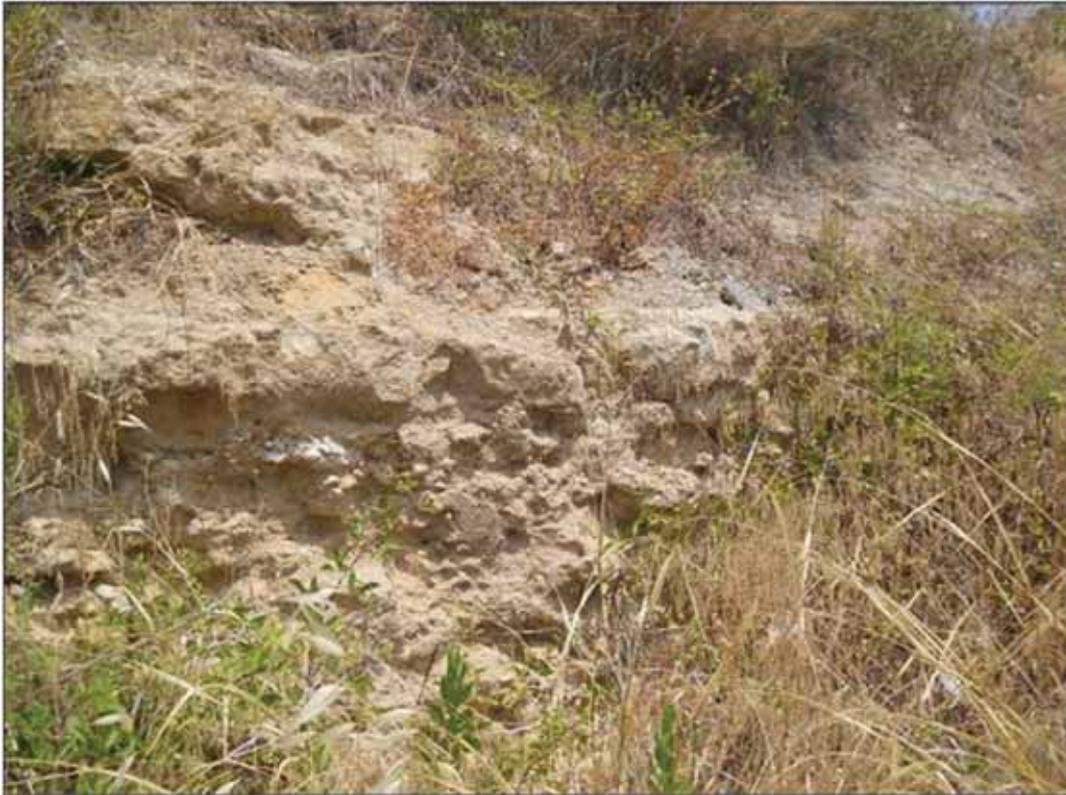
Foto 5-4 affioramento di depositi fluviali terrazzati pk. 4+550 (Foto PD)
