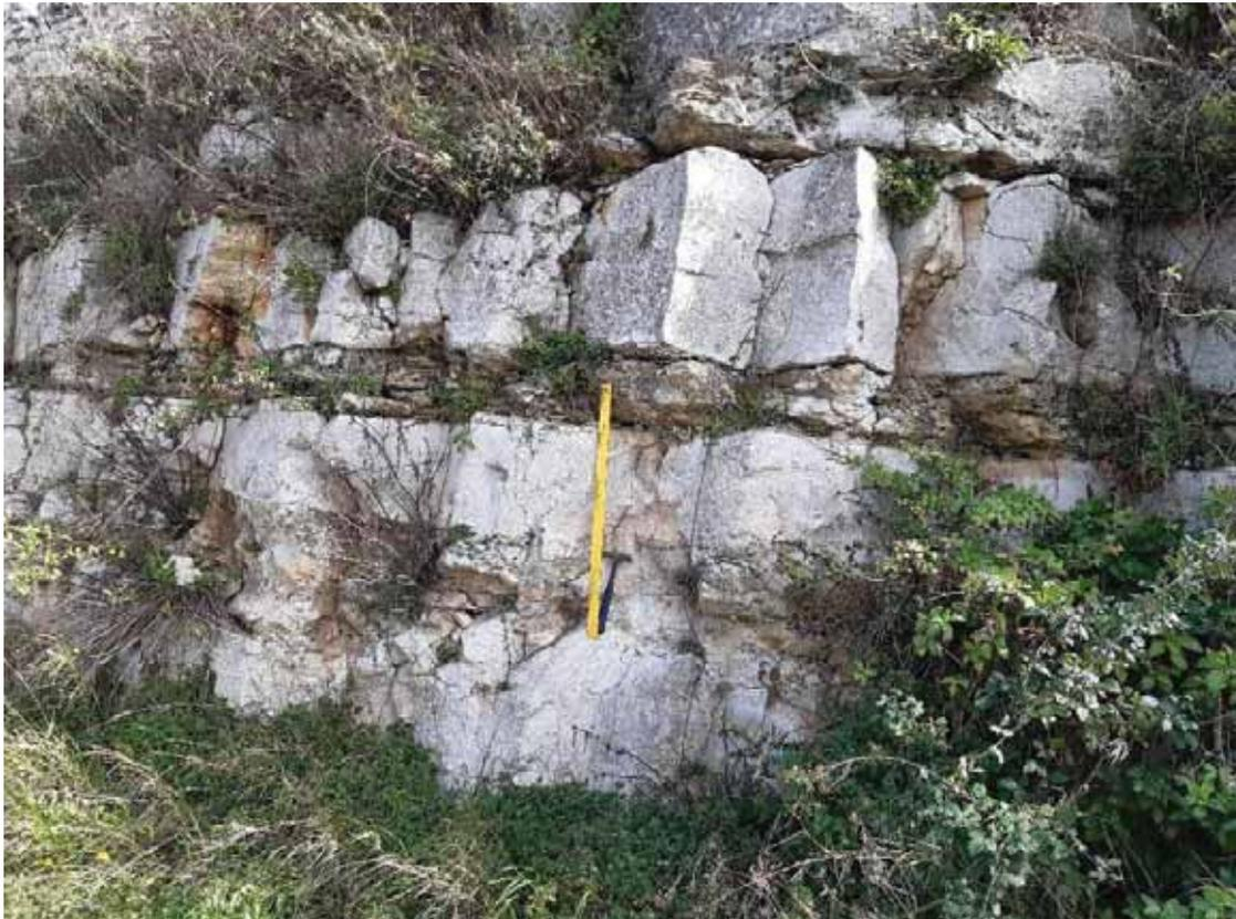
Foto 5-8 Alteranza di strati e banchi calcarenitici e calcareo marnosi, Formazione Mcm
