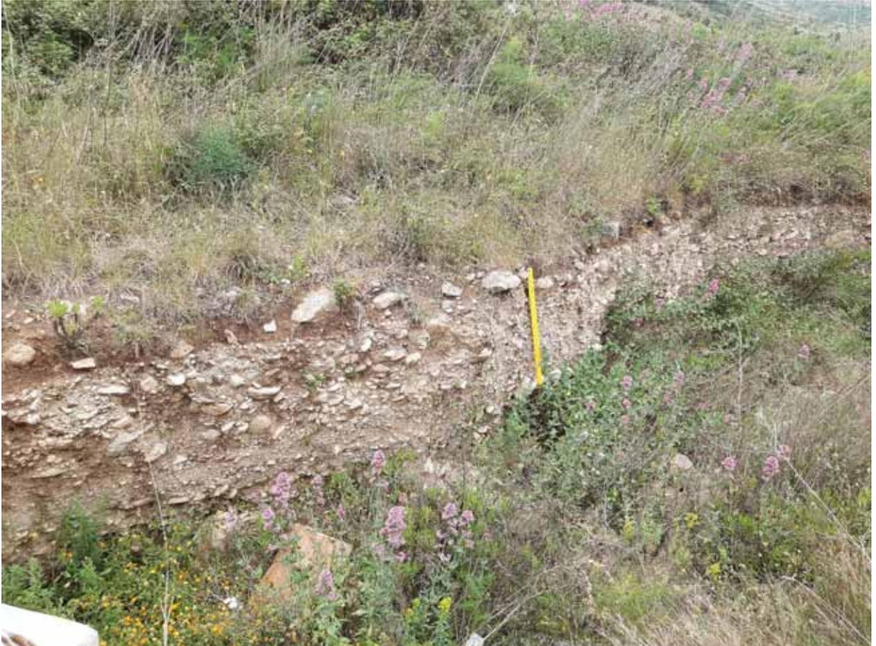
Foto 5-3 Depositi alluvionali in corrispondenza del Viadotto delle Coste
