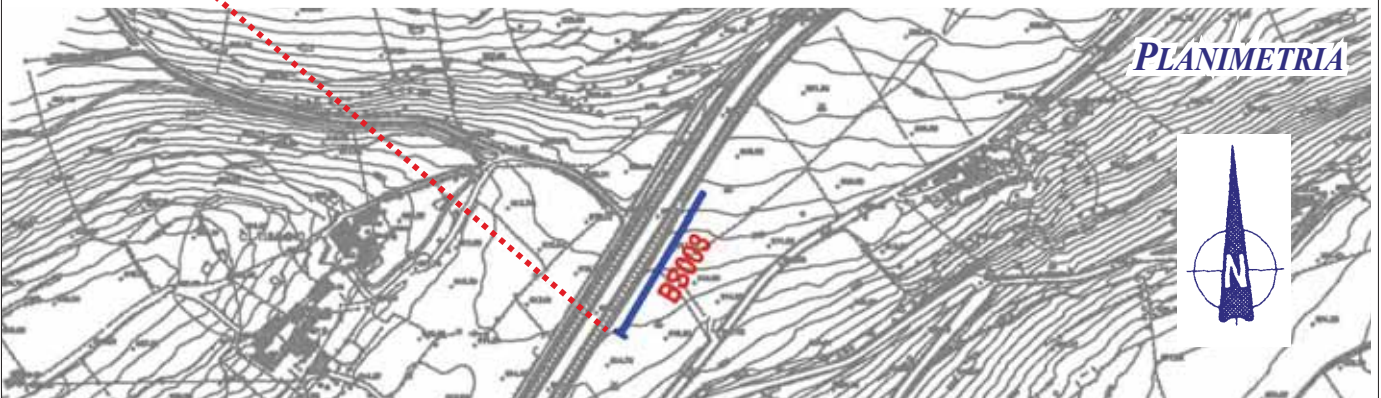
Geometria stendimento geofonico da 115 ml
