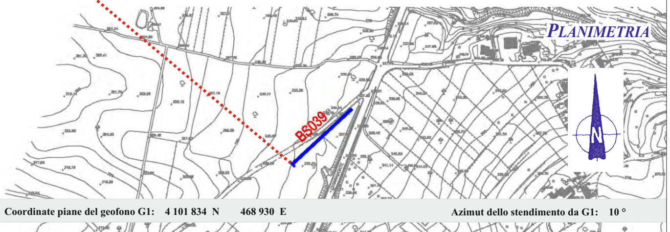
Geometria stendimento geofonico da 115 ml
