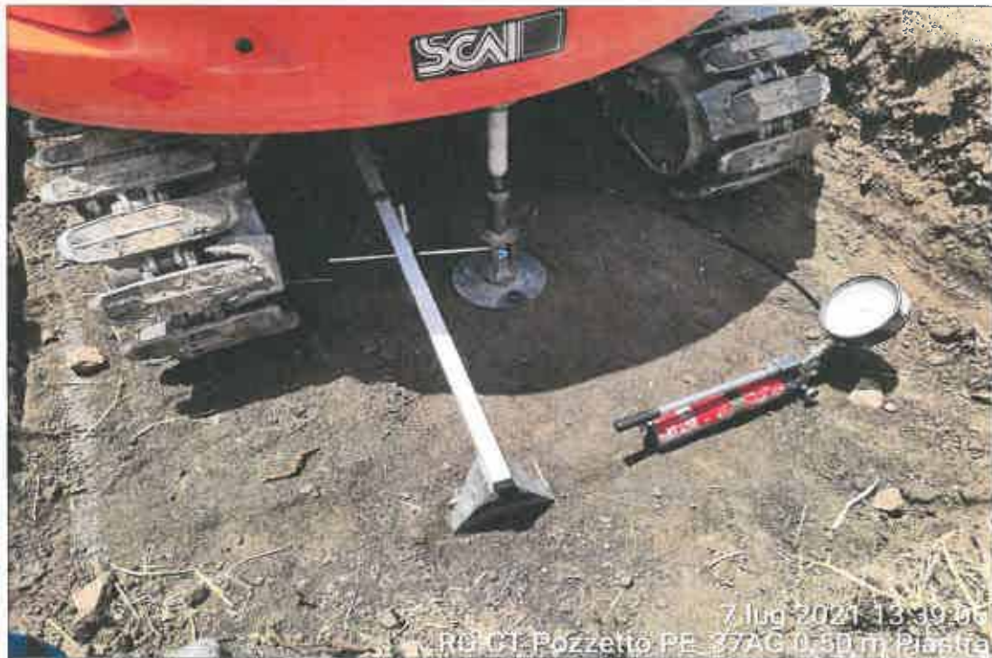
Esecuzione prova a carico su piastra
