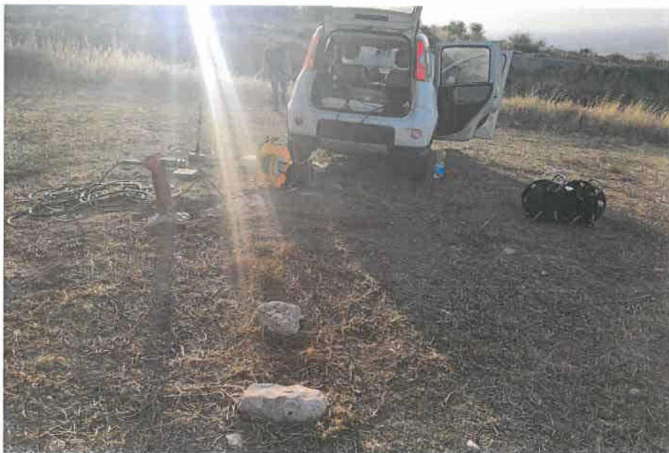
Foto 1 - Esecuzione della prova geofisica Down-Hole
