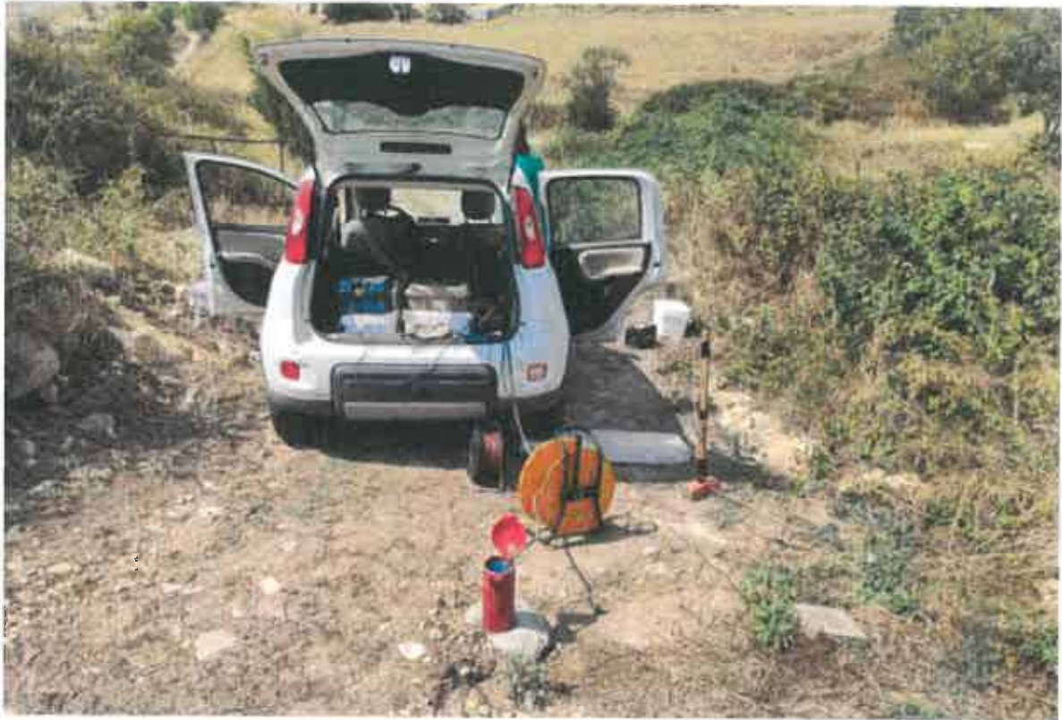
Foto 1 - Esecuzione della prova geofisica Down-Hole
