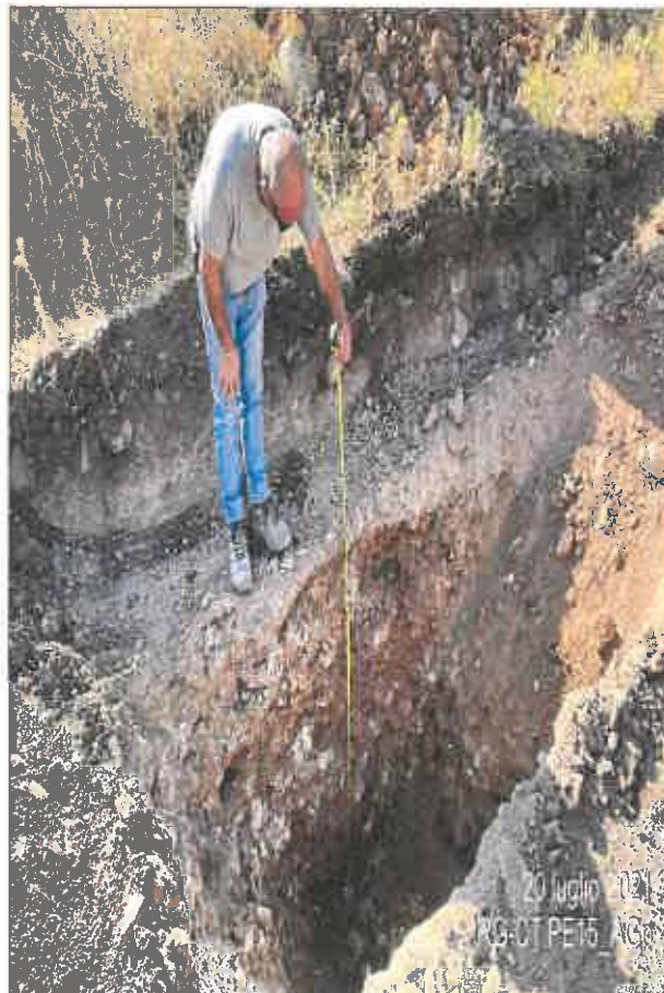
Pozzetto esplorativo - profondità da m 0,00 a m 2,00
