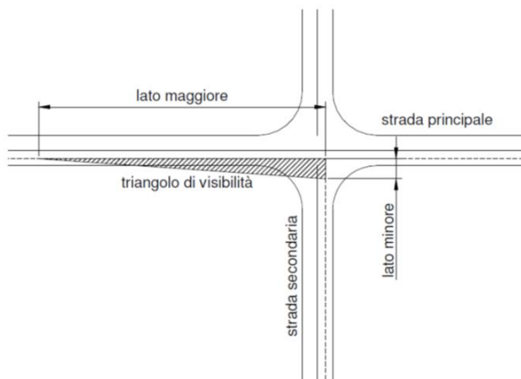
Figura 2 Schema di verifica dei triangoli di visibilità delle intersezioni - D.M. 19/04/2006
