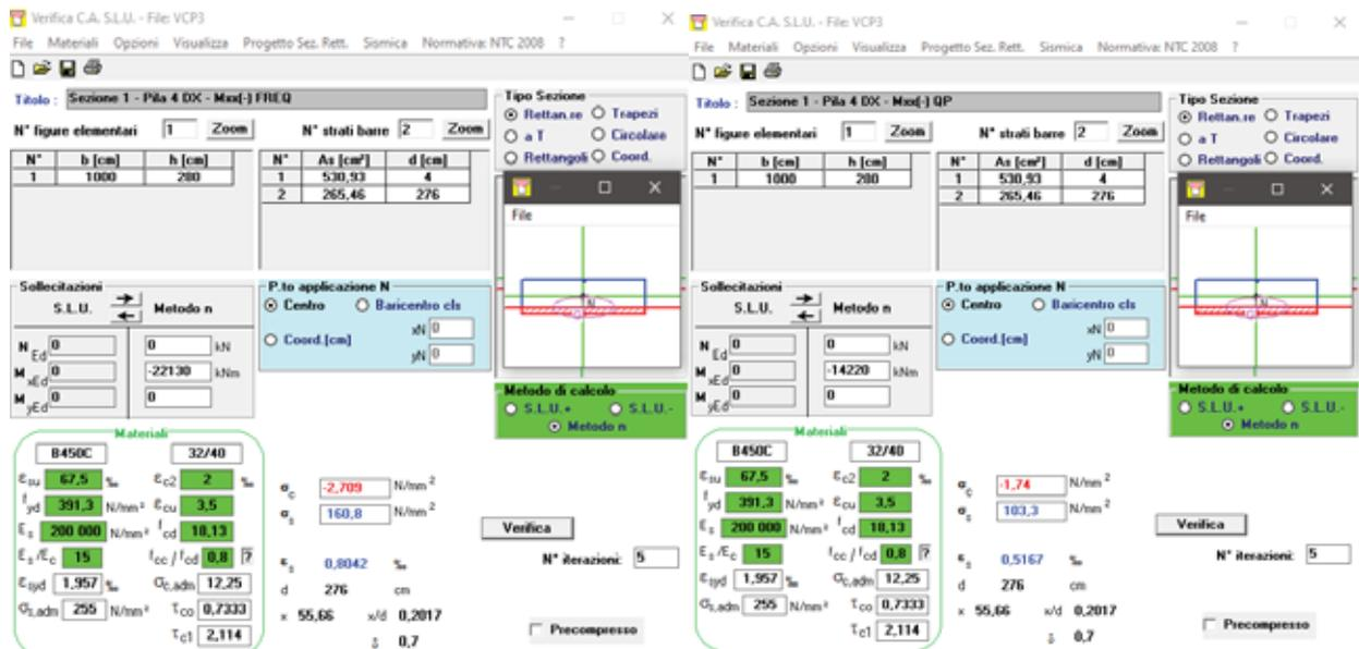
Di seguito si riportano le tabelle sintetiche di verifica a fessurazione con il calcolo del momento di prima fessurazione e dell'ampiezza di apertura di fessura per le combinazioni SLE frequente e quasi permanente. Le verifiche sono state condotte in conformità a quanto prescritto nell'EN 1992-1-1 cap.7.3.4.
