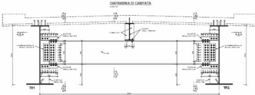
Figura 71 - Traverso di Campata
