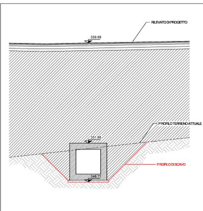
SEZIONE LONGITUDINALE OPERA FINITA
