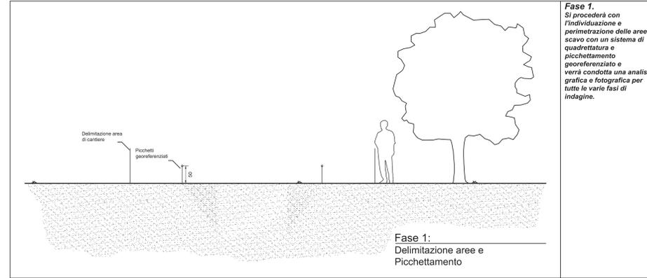
**Fase 1.** Si procederà con l'individuazione e perimetrazione delle aree di scavo con un sistema di quadratura e picchettamento georeferenziato e verrà condotta una analisi grafica e fotografica per tutte le varie fasi di indagine.
