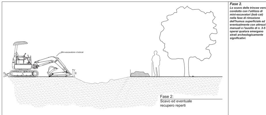
**Fase 2.** Lo scavo delle trincee verrà condotto con l'utilizzo di mini-escavatori (bob cat) nella fase di rimozione dell'humus superficiale ed eventualmente con attrezzi manuali e l'ausilio di n. 3-5 operai qualora emergano strati archeologicamente significativi.
