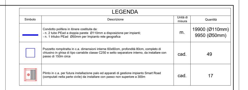
PER I PARTICOLARI DELLE SEZIONI RELATIVE AI PLINTI DEI PALI SI RIMANDA A QUANTO PREVISTO NELLA PARTE EDILE E STRUTTURALE.
