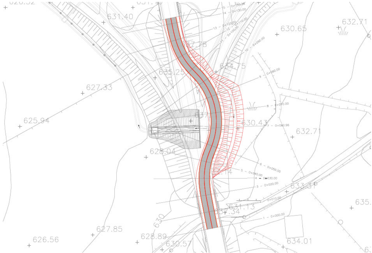
Figura 6.5 Deviazione provvisoria in corrispondenza dello svincolo sulla SS115
